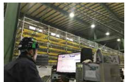
小ロット、多品種に対応した自動倉庫
